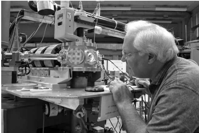
El Dr. Mario Debray (CNEA-UNSAM) observando el interior del microhaz del TANDAR, un dispositivo que permite testear aspectos críticos del acelerador.
