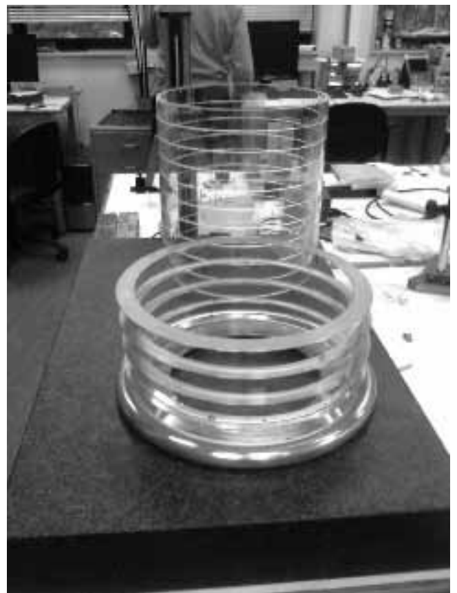
Primer prototipo de tubo de aceleración (fabricado por el Lic. Daniel Cartelli y el Tecnólogo José María Kesque).
