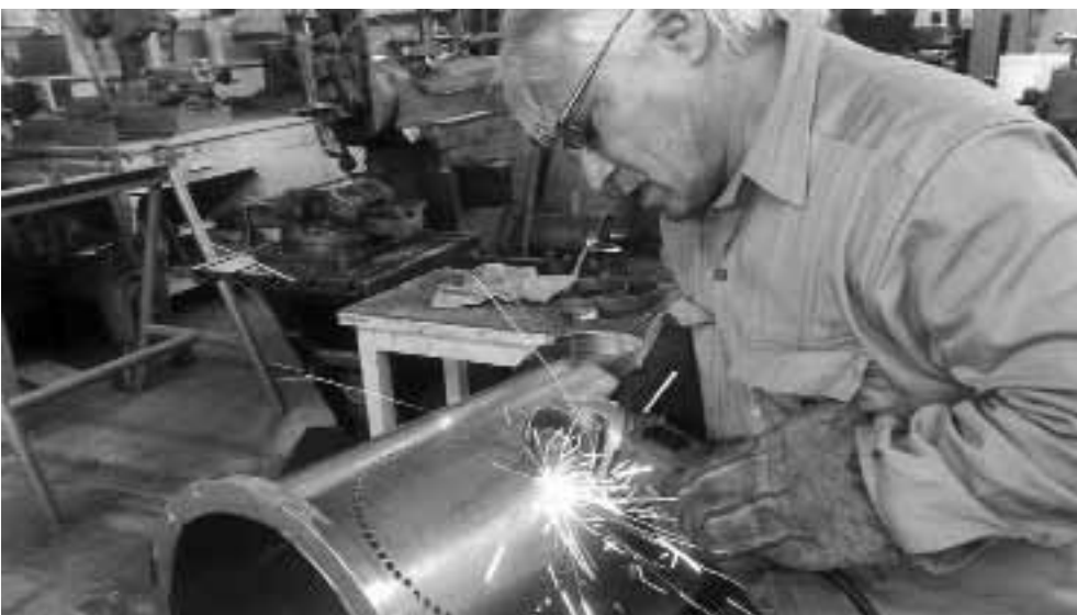
El Tecnólogo Hugo Zarate soldando una cámara de alto vacío.
